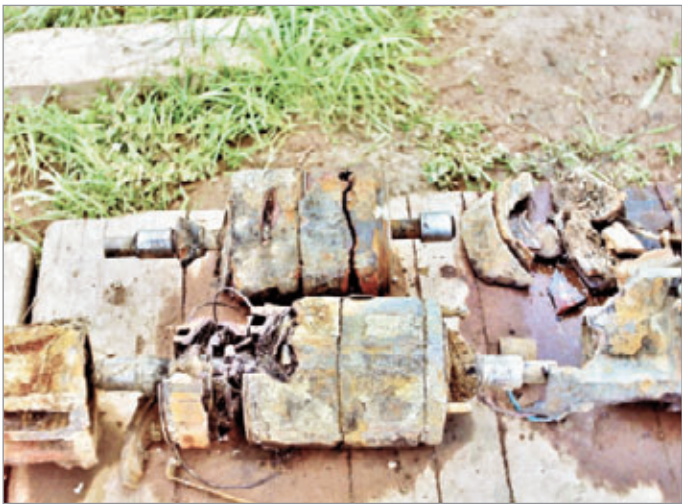
ten. Die Teile der durch den Absturz zerbrochenen Pumpen und die Bruchstücke der zerschlagenen Brunnenfilter sind deutlich erkennbar. Fortsetzung folgt Sebastian Weisz
